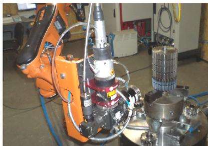
Рисунок 5 – Наладка манипулятора лазера для закалки следующего слоя
