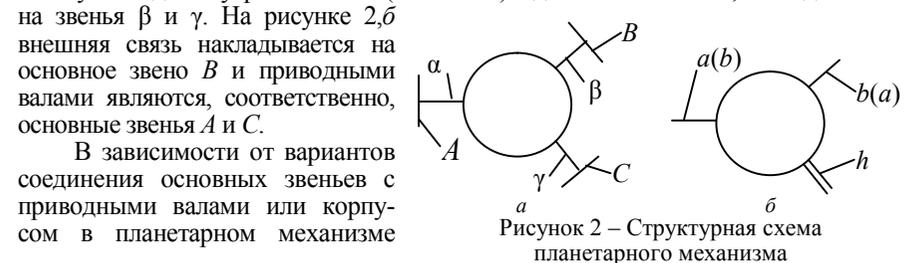
Рисунок 2 – Структурная схема планетарного механизма
