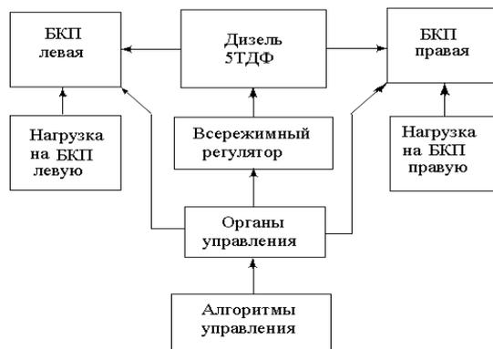
Рис.1. Структурная схема силовой передачи танка Т-64А
