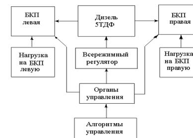
Рис. 1. Структурная схема силовой передачи танка Т-64А
